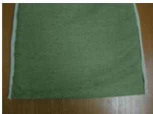
Типовая плотность брезента используемого при пошиве стандартных изделий – 400-450 гр/м<sup>2</sup>.
