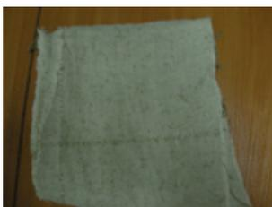
Самое уязвимое место любой сумки для инкассации – брезентовый чехол. На данном типе сумки он только из сурового брезента с различными видами пропиток и плотностью не менее 500-550 гр\м<sup>2</sup>.
